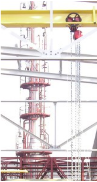
příklad využití pojízdného kladkostroje Brano
